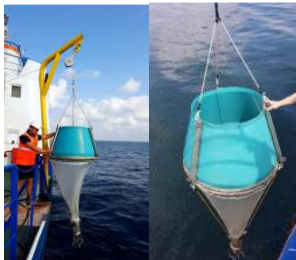
Figura II.92 Fileul Hansen pentru prelevarea probelor de macrozooplancton
